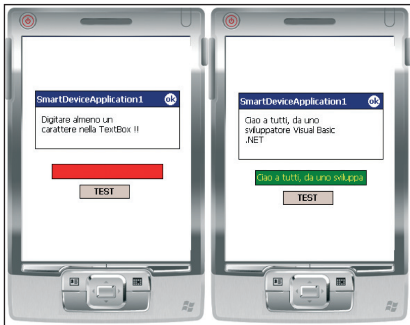
Fig. 11: L'emulatore in esecuzione visualizza due differenti comportamenti a seconda del ramo della If che viene seguito
